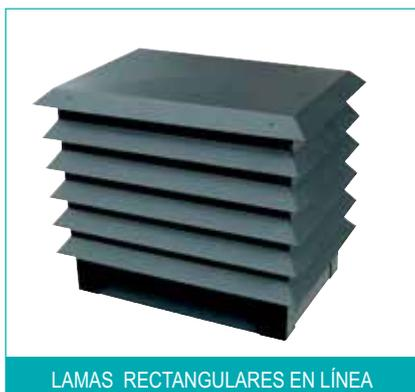
Este modelo de remate es el más antiguo y el más extendido en el mercado. Tiene sus lamas orientadas hacia el exterior en forma de "L" y superpuestas para ofrecer más resistencia a la entrada de agua. Puede suministrarse con el faldón interior a las lamas o en línea con estas. Indicado para zonas donde el viento y la lluvia sean de carácter NORMAL / FUERTE.
