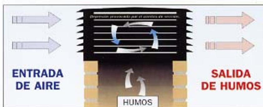
LA CORRIENTE DE AIRE AL ENTRAR ENTRE LAS LÁMINAS SE ESTRECHA, ESTO PROVOCA UN AUMENTO DE VELOCIDAD Y LA PRESIÓN BAJA (LA DEPRESIÓN PROVOCA LA SALIDA DE LOS HUMOS Y GASES).
